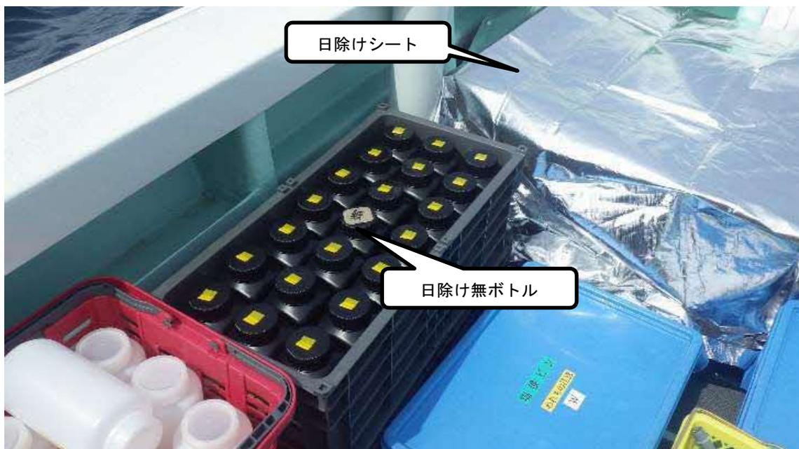
図1 実験時の採水容器・コンテナの配置と日除けの状況 (2023.7.4)
