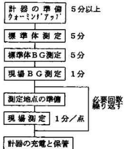
図-5 測定の手順の例
