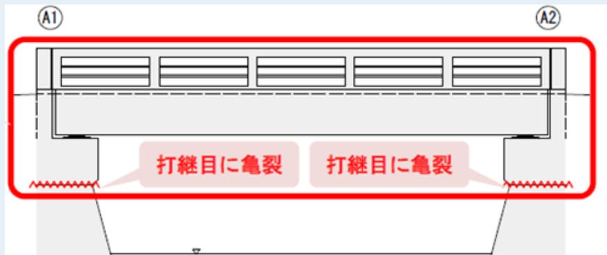
地震による外力で重力式橋台の水平打ち継ぎ目で完全分離し、回転している状況
