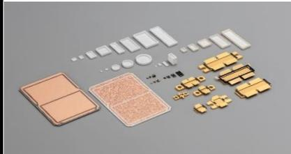
セラミック材料の中に電気配線を組み込んで電子部品を成形する「積層同時焼成技術」は世界で数社しかできない固有技術です。約半世紀の歴史を持つこの高い技術力に加え、最新の画像処理や自動化技術を取り入れて、現在の情報化社会にマッチする製品づくりを目指しています。
