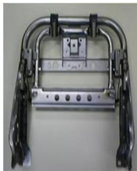
自動車フレームの受注に関し、試作、生産準備、プレス、溶接、組付け、検査（三次元測定器による）、出荷と一連の作業が全て出来る設備、スタッフを備えており、かんばん方式による効率的な生産体制を整えている。また、自社技術による改善で精算現場の負担軽減に取組、高品質な製品を短納期で供給できる。
