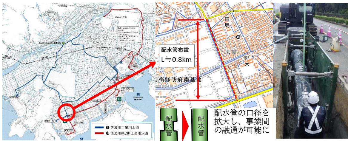
図3-6-1 《1期系管路（田島地区）改良工事概要図》
