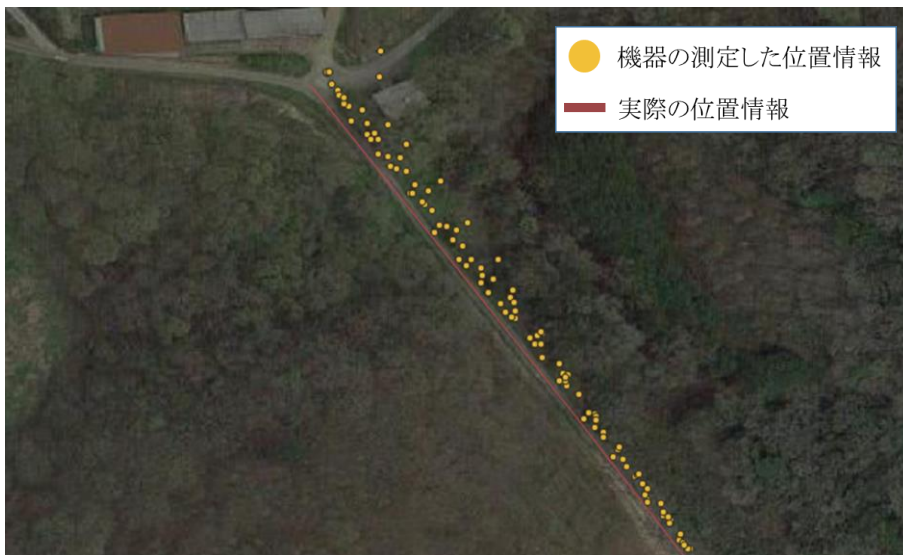
図2. うしみるの林間における測位精度
