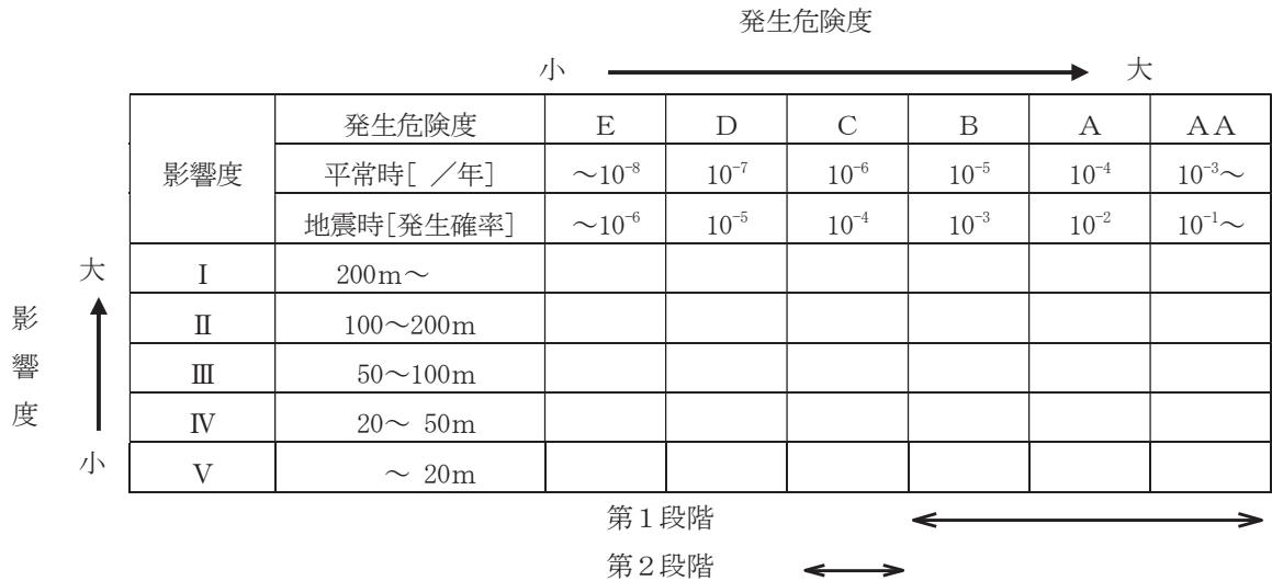
影響度の大きい災害についての対策を優先するとともに、発生危険度がAA, A, Bランクの災害（平常時は1施設当たり年間 $10^{-5}$ 件（10万年に1件）程度以上発生、地震時は $10^{-3}$ 件（1千施設で1件）程度以上発生。以下「第1段階の災害」という。）は現実に起こり得ると考えて、対策を検討しておくべき災害として捉え、発生危険度がCランクの災害（平常時は1施設当たり年間 $10^{-6}$ 件（100万年に1件）程度以上発生、地震時は $10^{-4}$ 件（1万施設で1件）程度以上発生。以下「第2段階の災害」という。）は発生する可能性が相当に小さい災害を含むが、万一に備え対策を検討しておくべき災害と捉える。
