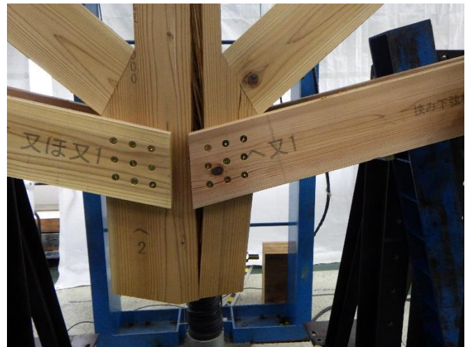
写真10 試験体の破壊状況（中部）
