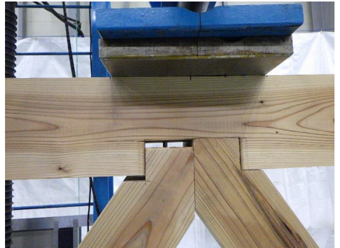
写真8 試験体の破壊状況（西部）
