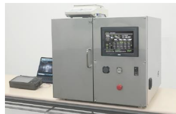
乾燥中の食品品質を観測する装置_（株）木原製作所
