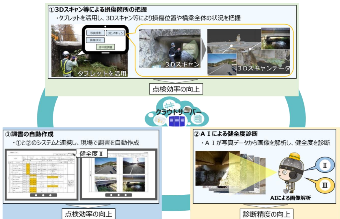
図 3-11 AI によるインフラ点検・診断システムの概要
