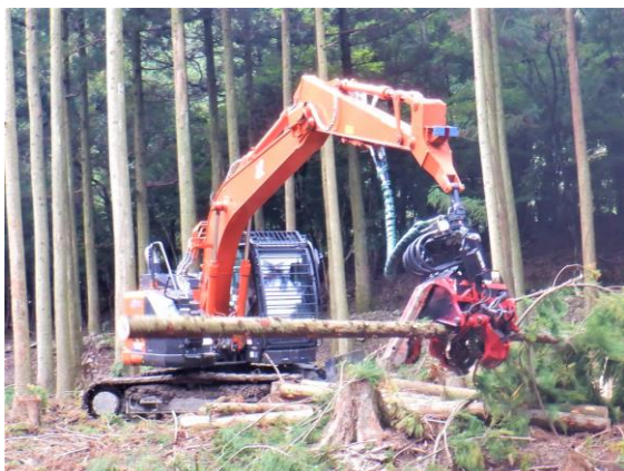
ICTハーベスタによる造材作業（三隅地区）
