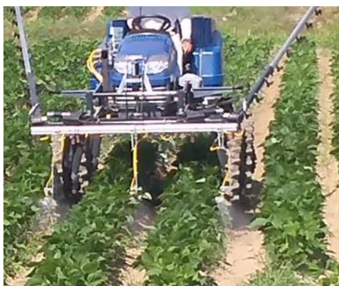
除草剤散布用吊り下げノズル
