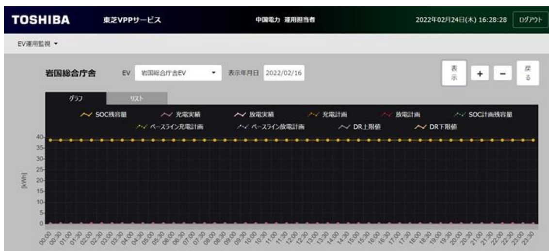
図 2-3-3 V2H の充放電電力および SOC 等の表示画面
