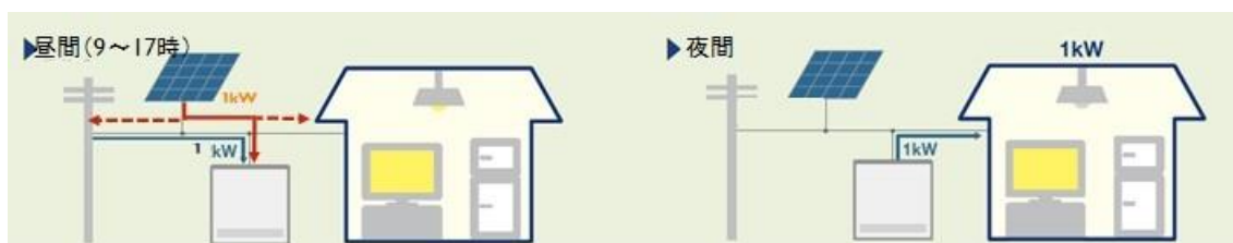
図 3-4-6 ピークシフトモードの模式図
