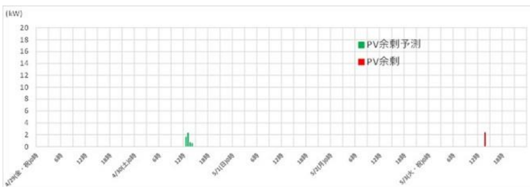
図 2-5-15 4月29日(金・祝)～5月3日(金・祝)分岩国高校のPV余剰電力の予測値と実績値の比較 (PV容量を40kWに増設したと仮定)
