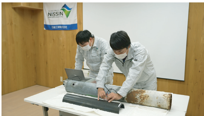
超音波データを解析し、劣化や不具合箇所の有無を判定
