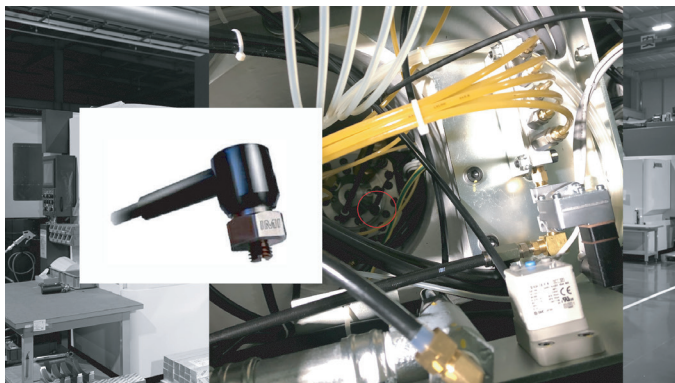
マシニングセンタ内に取り付けられた振動感知センサー
