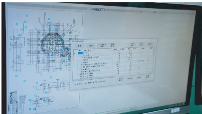
図面から穴の個数、直径、種類を自動で識別
