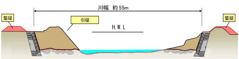
標準断面図 (現在工事箇所付近)
