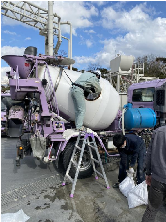
生コン車のハッチから 材料投入
