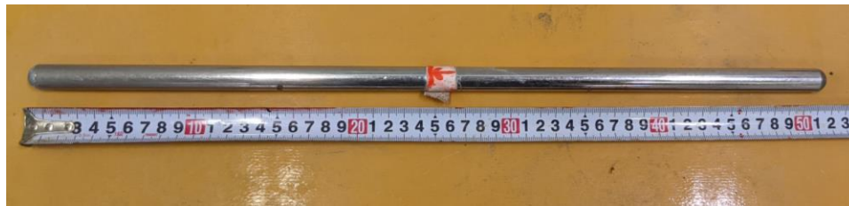
突き棒 … \phi 16 \times 520\text{mm} 、質量 814g
