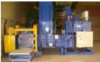
破碎後の廃棄物を圧縮し固形状（フラフ燃料）にします。
