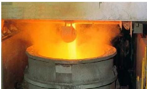
電気炉プラント設備(出鋼)
