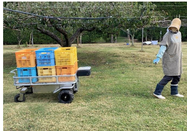
図5 120kgを運搬する様子
