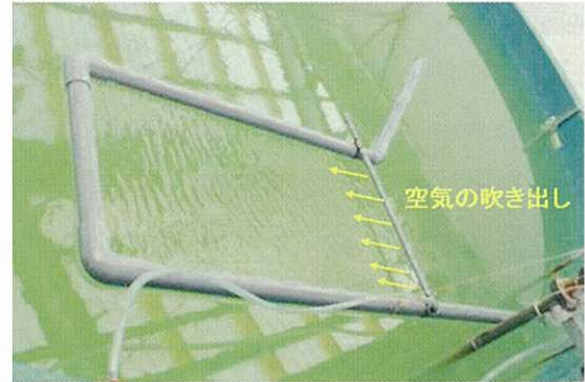
図3 試験に使用した油膜除去装置（空気を矢印の方向に吹き付けて水面の油膜を集めます）
