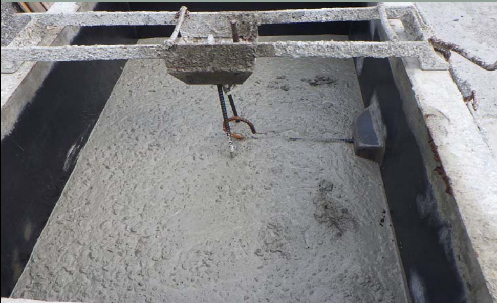
上部養生シートにて材齢7日間湿潤養生 材齢7日脱枠
